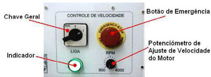
Figura 04. Controle de velocidades do conjunto (Fonte: Manual do aluno – BIT9)
