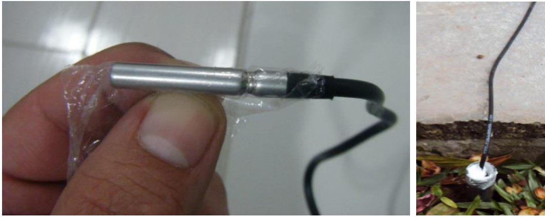
Figura 3 - Sensor (à esquerda) e montagem em tubo inserido no solo.
