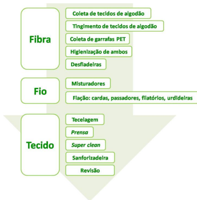
Figura 3. Processo produtivo do jeans com redução de impacto ambiental. Fonte: autores.
