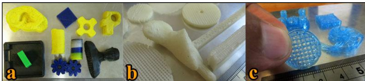
Figura 7 - Peças impressas na Fab@CTI com cabeçote FDM. a) Peças de ABS; b) Peças de PCL; c) Peças de PLA.
